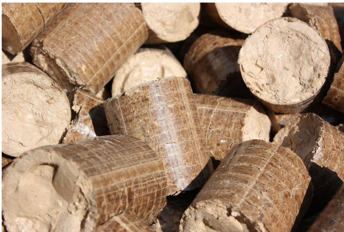
Slika 1 - Briketi. Površina se sveti zaradi velikega pritiska med izdelavo in ne zaradi kakršnih koli dodatkov. Nekateri peleti imajo v sredini luknjo za lažje gorenje.
