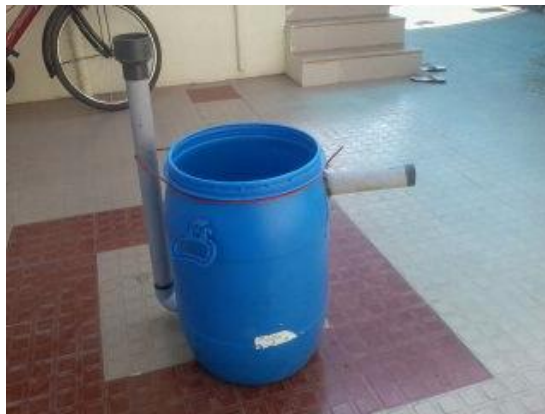
Slika 4 - Primer posode, na pokrovu bi bila še vrelna veha za izhajanje nastalega plina.
