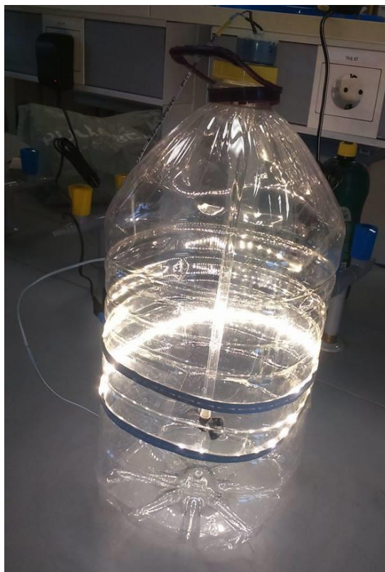
Slika 1 - izdelan bioreaktor. Na vrhu je na pokrovčku nameščen elektromotor za mešalo, ki sega v spodnji del posode. Okrog plastenke je nameščen LED trak.
