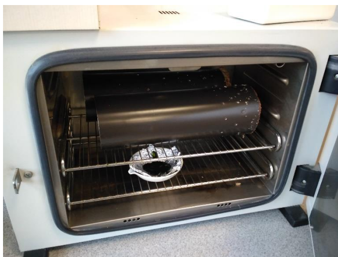
Slika 2 - Sušenje alg v sušilniku.
