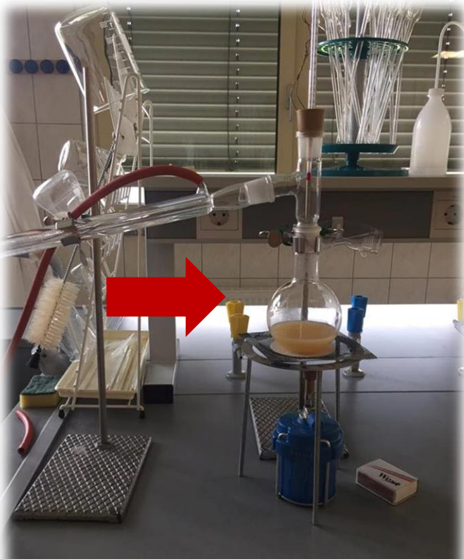
Slika 11: Nad gorilnik postavimo sok s kvasovkami ter ga segrevamo do temperature 78 °C. Na drugi strani hladilnika se izloča nastali bioetanol.
