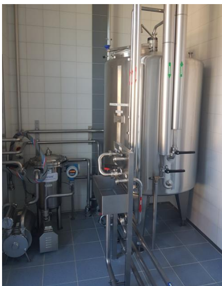
Slika 24: Cisterna za sprejem mleka Vir: Kaja T. Rozman (5. 06. 2021)
