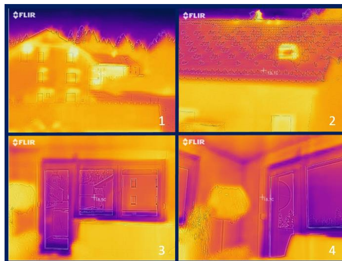
Slika 2: Primeri toplotnih izgub stanovanjskih stavb
