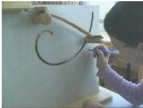
Slika 1: Preizkušanje žilavosti lesa (Sušnik, 2005)
