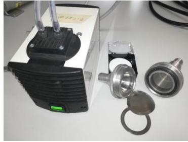
Slika 1: Sistem vzorčevalnika, črpalke ter kvarčnih filtrov
