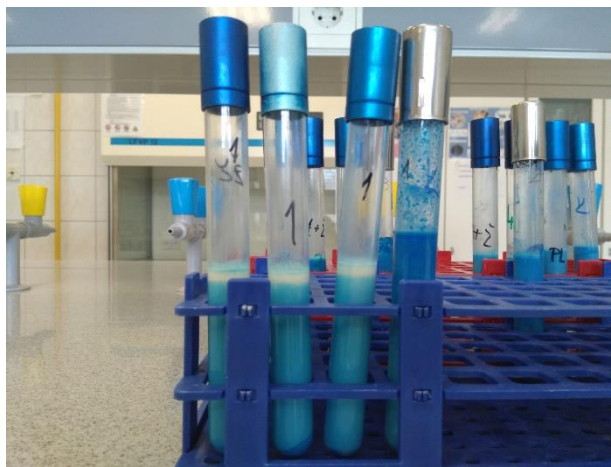
Slika 3: Rezultati vzorcev spremembe barve z redukcijo metilenskega modrila (primerjava prvih treh paralelk istega vzorca mleka s skrajno desno kontrolno epruveto)
