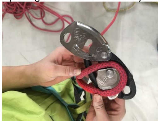
Slika 2: Prikaz pravilno vstavljenje vrvi (osebni arhiv)
