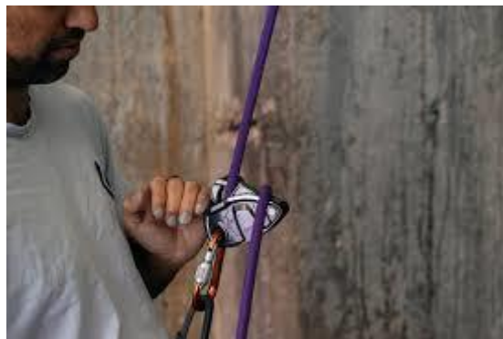
Slika 5: Prikaz manevra spuščanja z »ročko« ob spustu
