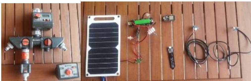
Slika 11: Osnovni elementi krmiljenja in zajemanja podatkov
