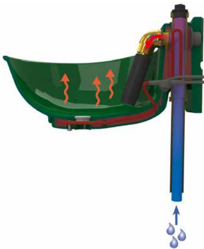
Slika 3: Shema delovanja enega od možnih načinov ogrevanega napajalnika VIR: https://www.kmetijskaoprema.si/ (1. 11. 2019)
