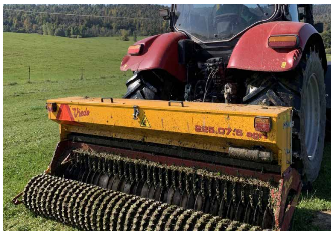
Slika 4: Neposredna setev s sejalnico Vredo DZ 229.07.5 agri, KMG Miklič Vir: Arhiv Ring, d. o. o.
